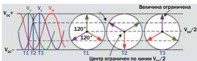
Форма сигналов напряжений при синусоидальной коммутации и их векторная диаграмма
